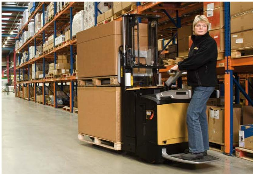
Diseñada para el transporte eficiente de palets, la **NPV20ND** permite el movimiento de dos palets simultáneamente. Esto hace que sea ideal para la carga y descarga de camiones ya que puede apilar los palets a dos alturas, uno encima del otro.
