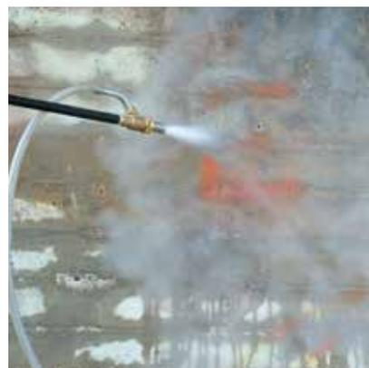
**Graffiti Waster** es un generador de vapor autónomo con caldera diesel que permite remover el graffiti y la suciedad en general, gracias al revolucionario sistema que combina vapor/arena y vapor/detergente.
