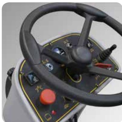
panel de control, el operador puede ajustar la velocidad de trabajo y la cantidad de solución de limpieza, seleccionando la opción más adecuada para cada tipo de suciedad. El trabajo se simplifica y hace más rápido gracias a el sistema automática de levantamiento de la boquilla de secado y de los cepillos
