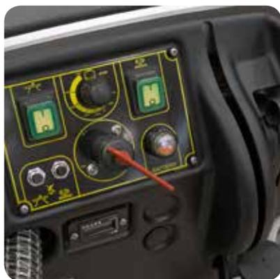
Panel de control analógico, fácil y intuitivo. Palanca de transmisión del cepillo y de la solución detergente. Llave de encendido/apagado y de exclusión de la batería, interruptor motor cepillo y motor de aspiración, sistema de dosificación de los productos químicos (opcional), disyuntor térmico para proteger el motor cepillo y el motor de
