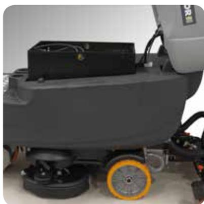
C5, que permite un tiempo continuo de trabajo hasta 5 horas. Construida con materiales sólidos, Comfort S-R ha sido estudiada para resistir a fuertes golpes; el chasis está construido de perfiles de acero con un espesor que varía de 5 a 12 mm, protegidos por una pintura anti-corrosiva
