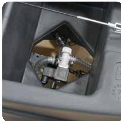
Boquilla de secado renovada con un nuevo sistema para la regulación de la presión. Los labios de goma son fácilmente sustituibles sin el uso de herramientas. Enganche de la boquilla de secado rápido y sencillo; la boquilla de secado se libera sin ningún daño en caso de choque accidental.
