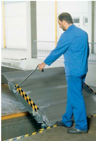
Bajando la plataforma SKB con palanca retroceso.
